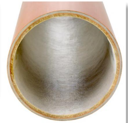
Außen: das alte Rohr. Innen: der ausgehärtete Inliner.
