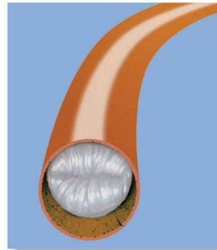
Der Inliner drückt sich durch das bestehende Rohr. Aus dem, was hier wie ein Mund aussieht, entfalten sich weitere Zentimeter, Dezimeter, Meter – bis alles ausgekleidet ist.
